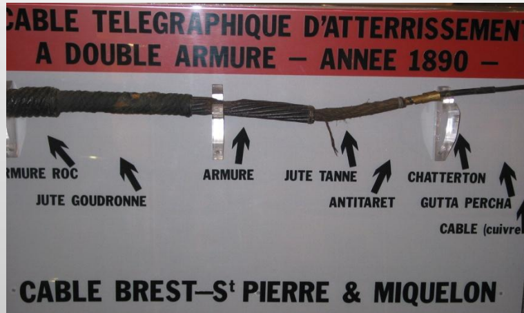
Armure Roc - Jute goudronné - Armure - Jute tanné - Antitaret - Chatterton - Gutta percha
