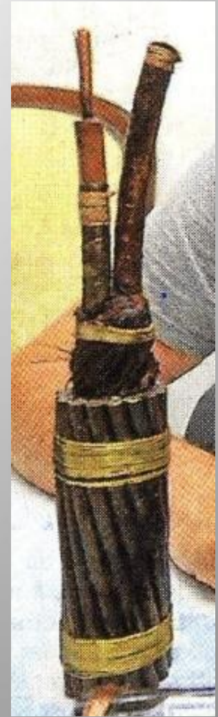
Armure Roc - Jute goudronné - Armure - Jute tanné - Antitaret - Chatterton - Gutta percha
