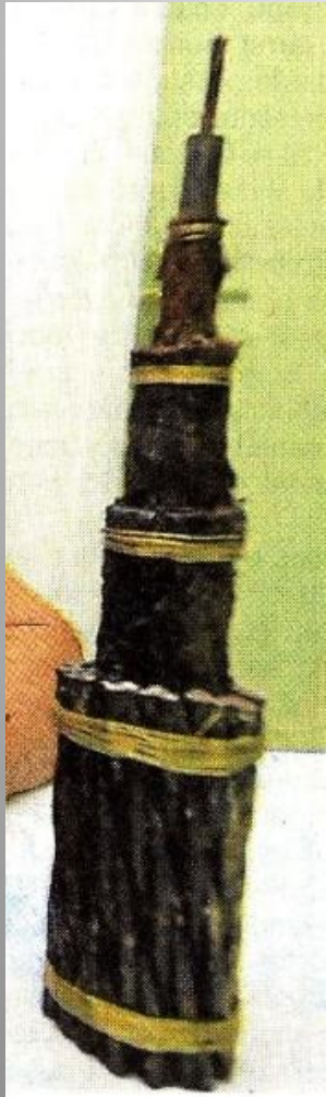
Armure Roc - Jute goudronné - Armure - Jute tanné - Antitaret - Chatterton - Gutta percha
