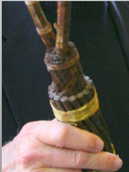
Armure Roc - Jute goudronné - Armure - Jute tanné - Antitaret - Chatterton - Gutta percha
