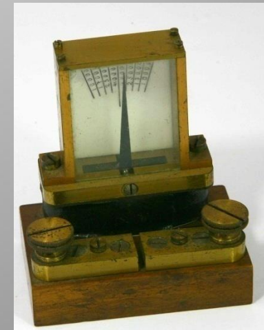
Galvanomètre Siemens et Halske Wien R = 45 ohms
