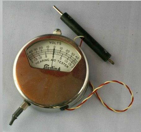
Voltmètre à point Milieu à 2 positions 2 V et 50 V
