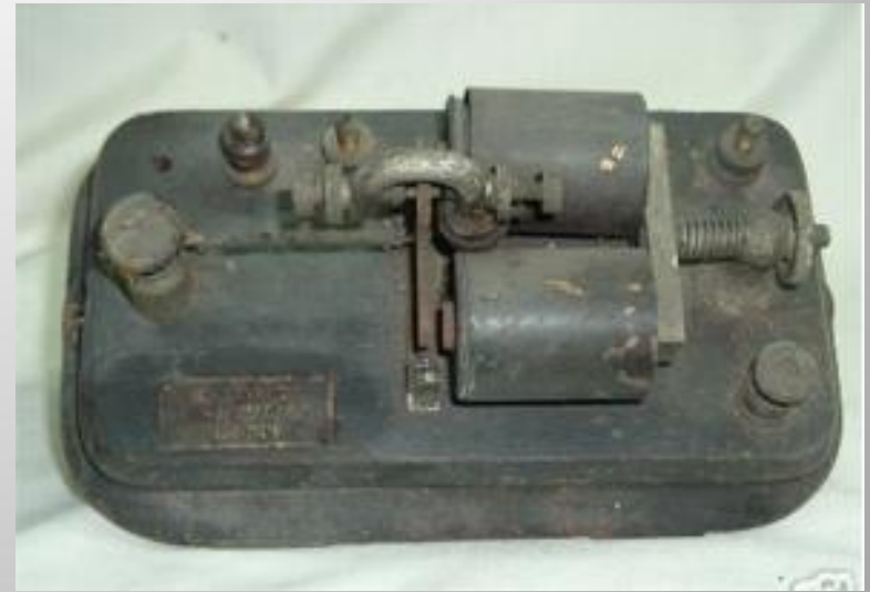
Relais terminal relié à l'alimentation à travers un relais de ligne de type 4C Provenance : Greenville - Pensylvanie
