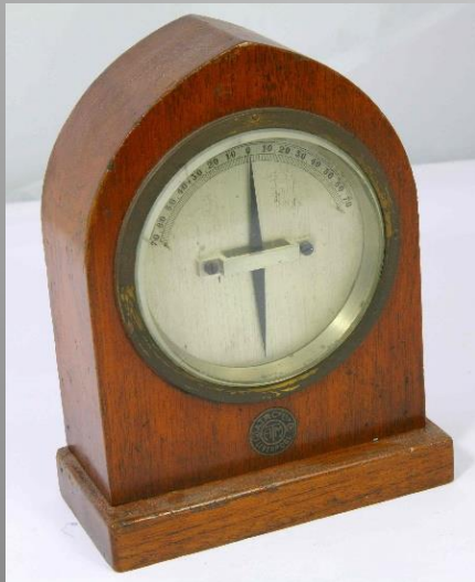
Galvanomètre ATM Liverpool – G.B. à simple courant. L'instrument a une résistance de 30 ohms.
