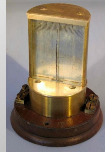
Galvanomètre E. Gerard et Cie CDC nr 3613 1913 R = 100 ohms
