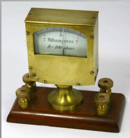
Galvanomètre 2 positions 7 ma R = 100 ohms 25 ma R = 20 ohms
