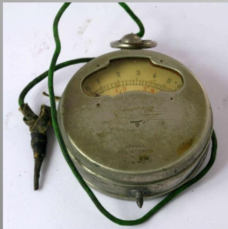
Voltmètre DRGM à graduations graduations 0 à 6 volts et 0 à 120 volts
