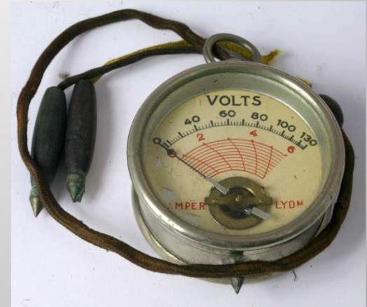
Voltmètre à deux graduations 0 à 6 volts et 0 à 120 volts
