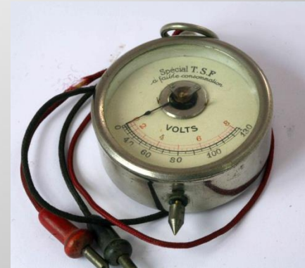
Voltmètre spécial TSF à deux graduations 0 à 8 volts 0 à 130 volts
