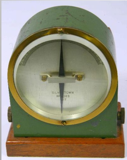
Galvanomètre Silvertown à simple courant nr 2089 1917
