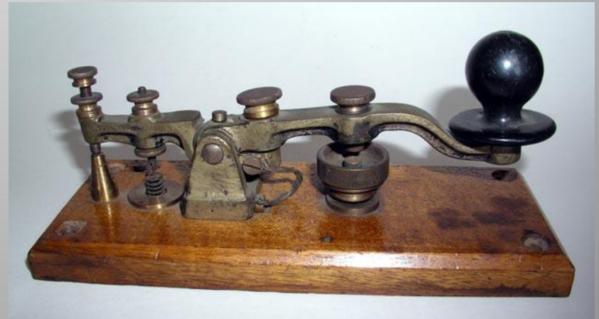
Manipulateur « propriété de la Radio-Maritime » à godet de pétrole, un levier articulé et un bouton rond inhabituel,
