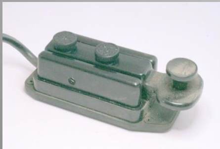
Manipulateur Manitown (modèle 29416) qui équipait les avions Caravelle (en 1958)
