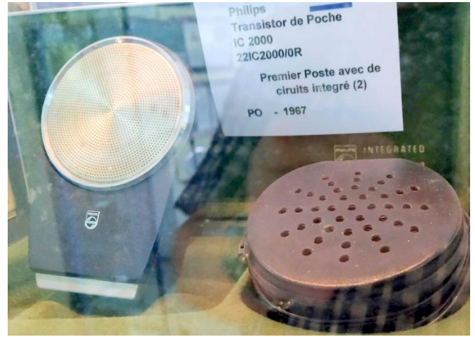
Premier poste Philips (PO) à 2 circuits intégrés (1967)
