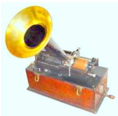
L'un des premiers appareils d'Edison à cylindre cannelé et feuille d'étain
