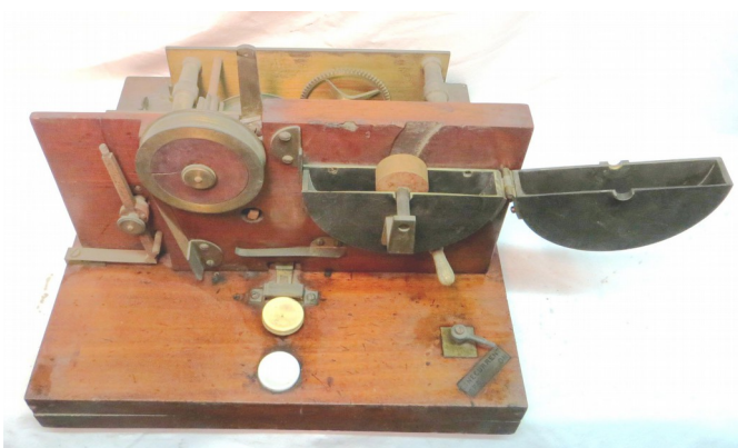
Récepteur système BAIN à inscription électrochimique
