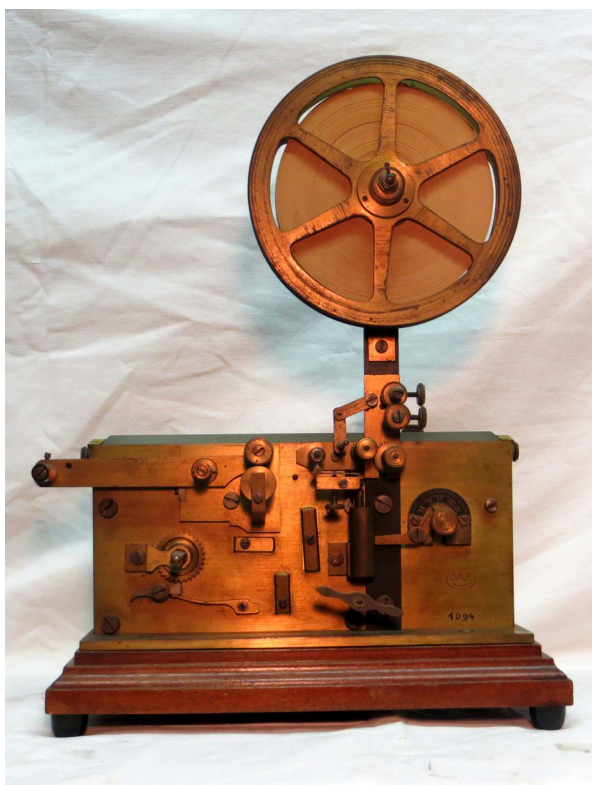
Récepteur système HIPP – Il constitua la norme du récepteur télégraphique italien pendant près de 100 ans, fabriqué à des milliers d'exemplaires et chez tous les constructeurs italiens.
