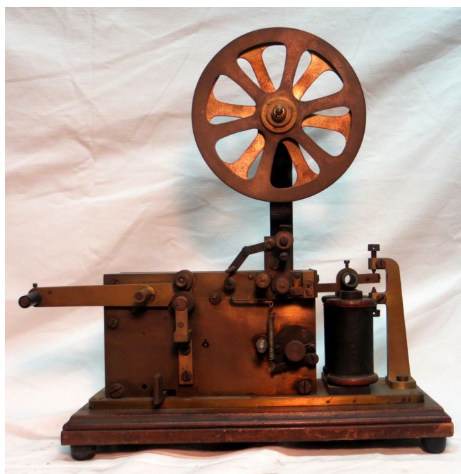
Récepteur système HIPP – Construction SIEMENS-HALSKE. Ce type de récepteur est probablement arrivé en Italie après la première guerre mondiale avec l'annexion des territoires anciennement autrichiens.
