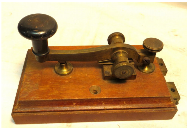
Deux manipulateurs Morse de type Autrichien utilisées dans les territoires Italiens sous contrôle des Habsbourg
