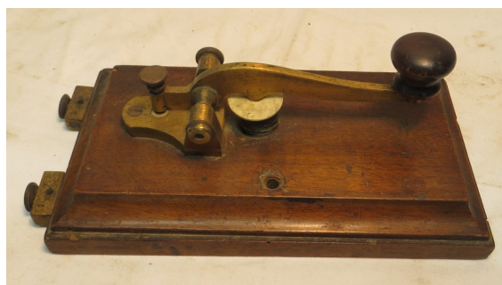
Deux manipulateurs Morse de type Autrichien utilisées dans les territoires Italiens sous contrôle des Habsbourg
