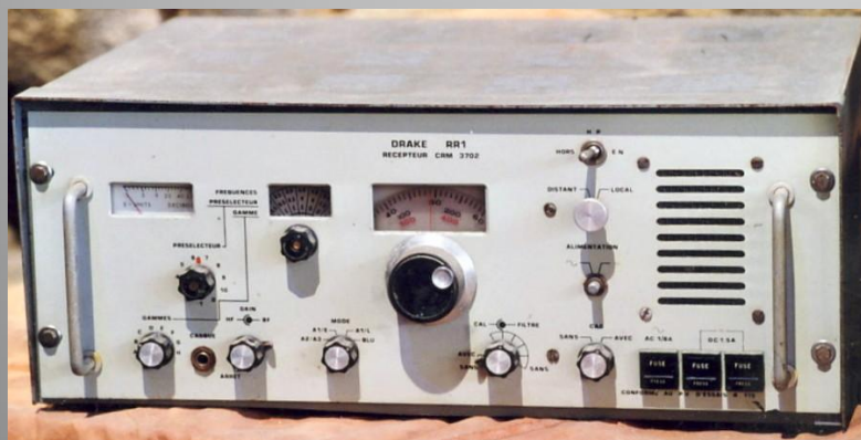
Récepteur Drake RR1 type 3702 6 CRM provenant du « Noroît », navire océanographique, de Génavir - Ifremer
