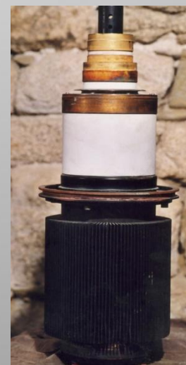
Tube d'émission « Vapotron° LF (low fréquences)) Chauffage : 12 v - 480 ampères
