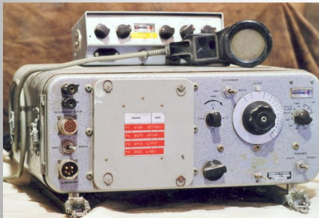
E/R MF et HF type TRMM3 ou THC 482C Frq : 2 mhz à 20 mhz
