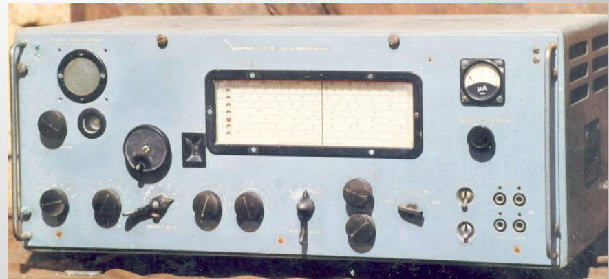
Récepteur HF AME - type 7G - 1680 Frq : 1,7 mhz à 40 mhz
