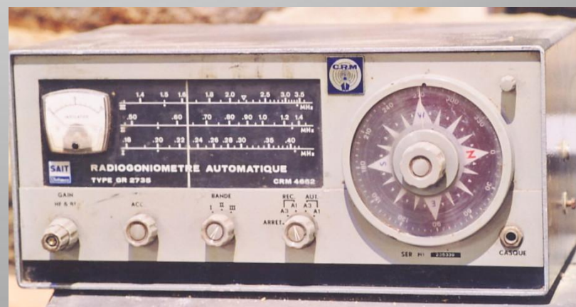
Radiogoniomètre automatique type GR 2735 CRM
