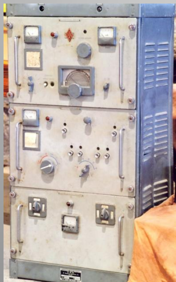
E/R de bord, type EBQ 3 utilisé dans les navires de la Marine Marchande
