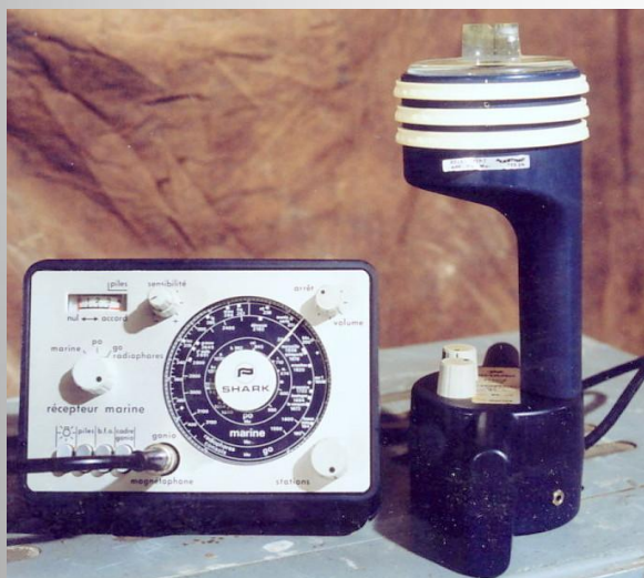
Radiogoniomètre Shark utilisé à bord des navires de plaisance
