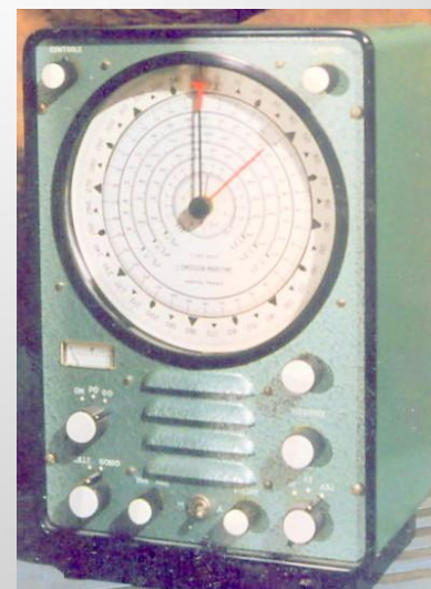
Radiogoniomètre type RG 47 de l'Emission Maritime de Nantes
