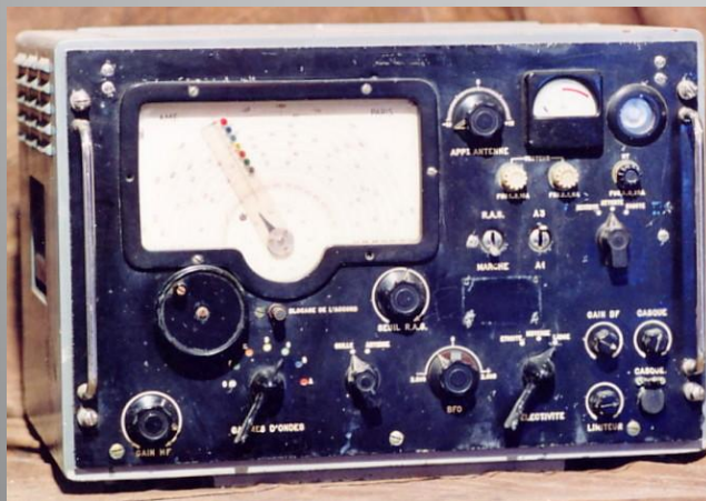
Récepteur AME type RRBM 3 Frq : 13 khz à 1,7 mhz
