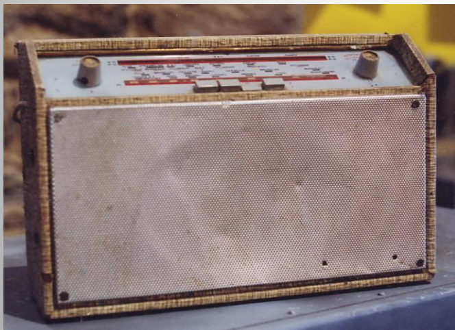
Postes à transistors utilisés à bord des navires pour écouter les signaux de Radio Consol de la station de Plonéis située près de Quimper
