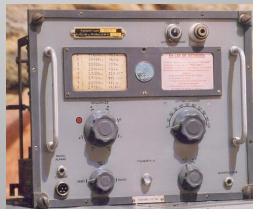
Partie émission d'un ensemble PNQ 15 - Naviphone - 30 watts
