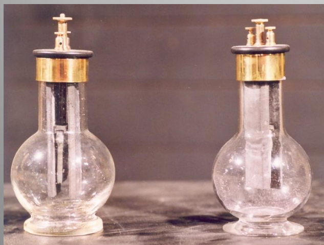
Pile de Grenet ou pile au bichromate de potassium La f.e.m. de ces piles est de l'ordre de 2 volts.
