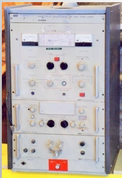
E/R de bord utilisé dans les navires de la Marine Marchande
