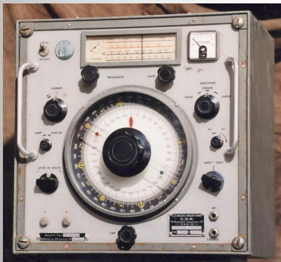
Radiogoniomètre type GFB 6 - CRM provenant du chalutier « Le Bambino » Armement Langlois -St Malo - 1954
