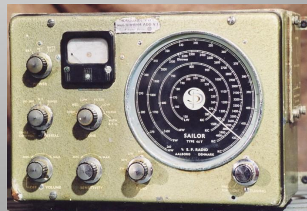
E/R MF Sailor type 46T en provenance de la vedette « Velleda » de l'île de Sein
