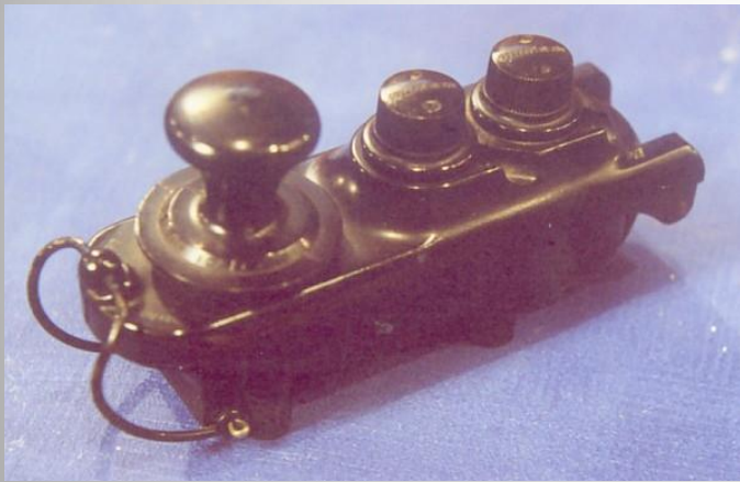
Manipulateur « Flameproof » RAF 1938 baptisé 'Bath tube » en raison de sa forme. Il était utilisé à bord des avions Sunderland et Lancaster (avec la station Marconi T 1154 et R 1155) pendant la WW2;
