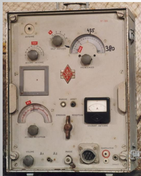
E/R SFR type TRBG 1 R : 200 à 750 khz E : 300 0 600 KHZ
