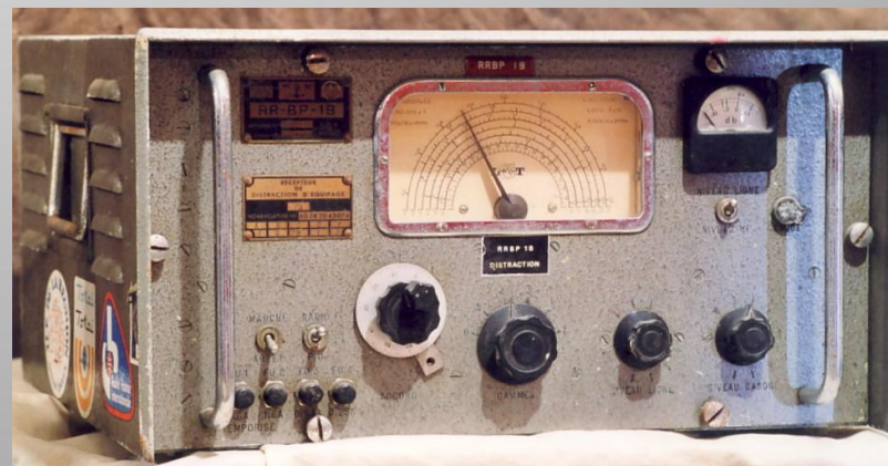
Récepteur de distraction d'équipage type RRB1A Frq : 150 khz à 21 mhz
