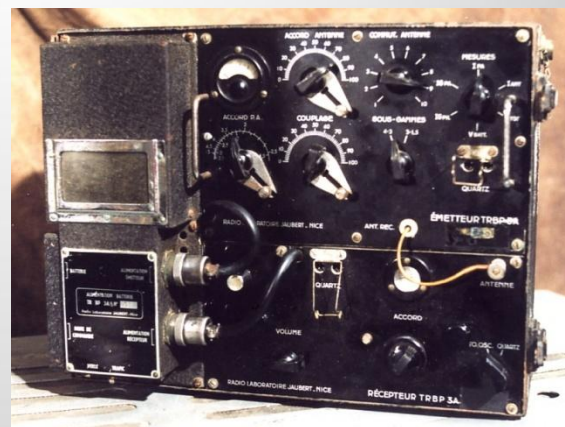
E/R MF portable type TRBP3A Radio Laboratoire Jaubert - Nice (1953)
