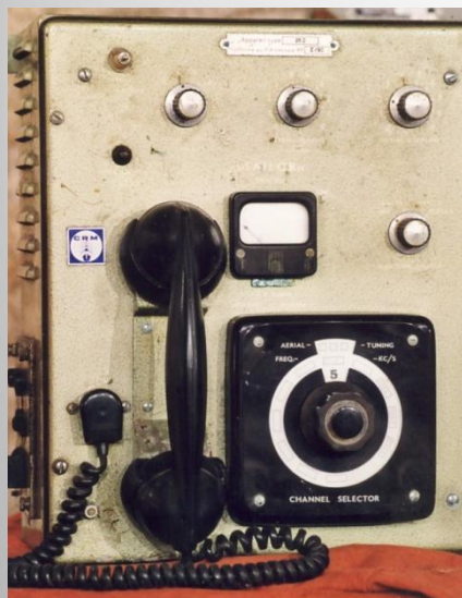
E/R MF Sailor type 26D provenant de la vedette « Velleda » de l'île de Sein
