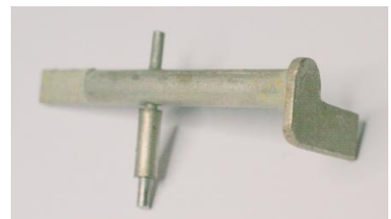
Actionnement de l'électro-aimant et tige de blocage du ressort moteur
