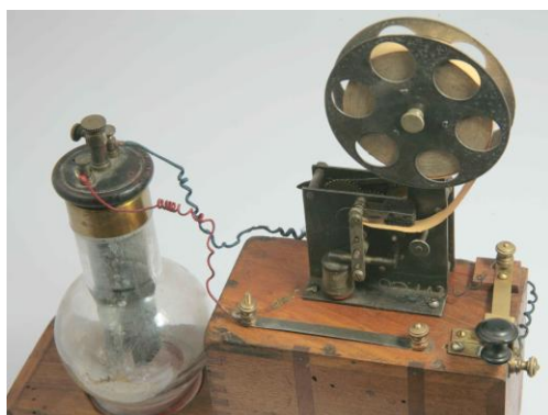
Autre ensemble télégraphique avec une pile Grenet Collection Michel Balannec
