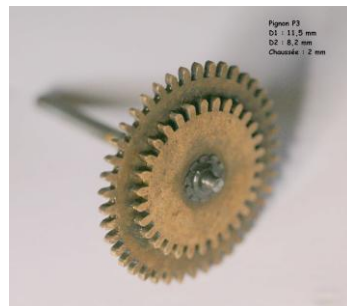
Pignon entraîné par la roue du barillet et prolongé par le cylindre entraîneur du papier
