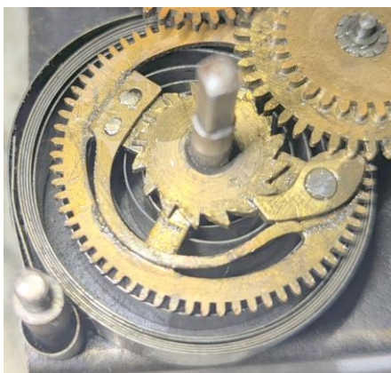
Ressort spiralé plat en acier. Roue de barillet comprenant le ressort de cliquet et l'arbre.
